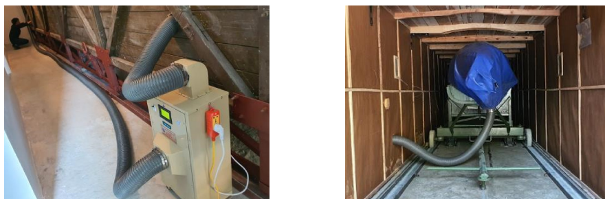
Hình 5. Triển khai hệ thống bảo quản tên lửa P-28 tại Vùng 1/QCHQ
