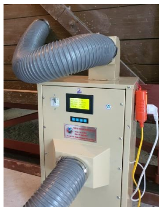
Hình 3. Máy thổi khí khô TTK-HQ1
