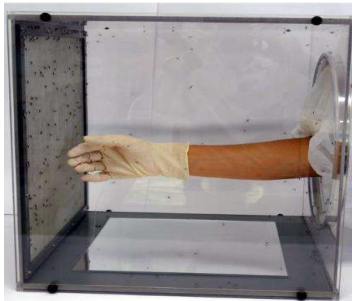
Hình 1. Thử nghiệm cánh tay trong lồng (arm-in-cage, AIC) để đo lường hiệu quả của thuốc chống muỗi tại chỗ trong điều kiện phòng thí nghiệm [11]
