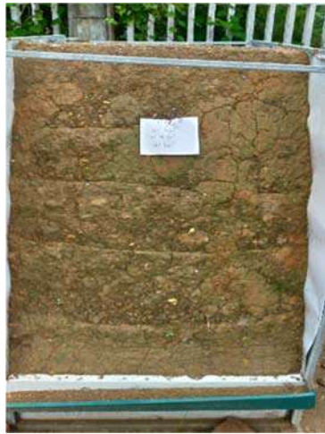
Các rãnh xói mòn, lớp đất bị bào mòn trên ụ 1
