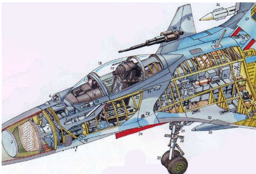
Hình 1. Các khối thiết bị vô tuyến điện tử trong khoang thiết bị máy bay Su-C
