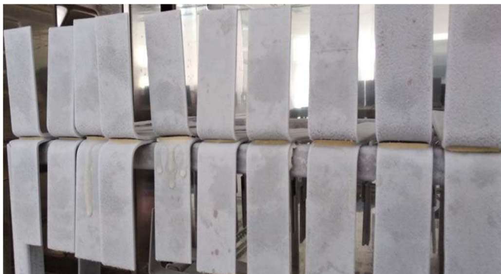
Hình 7. Mối nối keo bị bong tại vị trí uốn vuông góc khi thử nghiệm sức nóng
