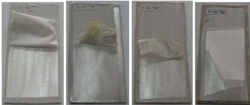
Hình 4. Từ trái qua phải: mẫu XC-567.VN trước thử nghiệm, sau 1 chu kỳ, sau 3 chu kỳ và sau 10 chu kỳ thử nghiệm
