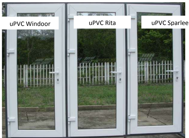
Hình 3. Mẫu thử nghiệm nguyên chiếc trên sân bê tông ngoài trời
