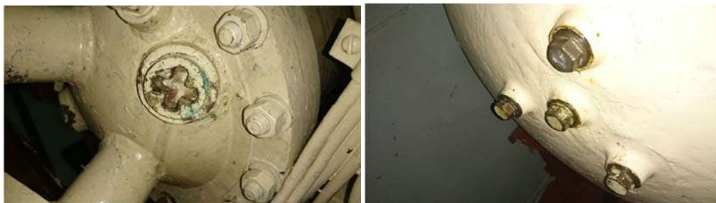
Hình 1. Các protector lắp trên tàu Đinh Tiên Hoàng 011
