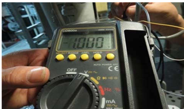
Hình 3. Đo điện thế phân cực protector Zn lắp đặt trên tàu
