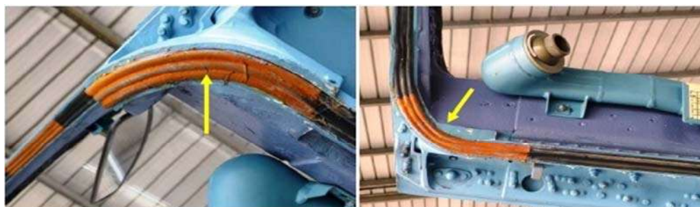
Hình 2. Vị trí sảm bịt kín trên máy bay họ SU bị hư hỏng được khắc phục bằng miếng dán (mũi tên chỉ vị trí miếng dán)
