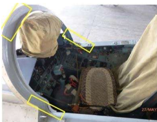
Hình 6. Ảnh thể hiện các khu vực bắt buộc phải xử lý bằng hợp chất diệt khuẩn trên máy bay một chỗ ngồi
