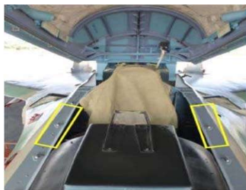
Hình 7. Ảnh thể hiện các khu vực bắt buộc phải xử lý bằng hợp chất diệt khuẩn trên máy bay hai chỗ ngồi
