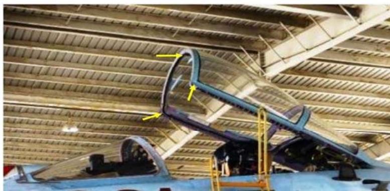
Hình 3. Các vị trí trên tấm bịt kín khoang lái bị hư hỏng phổ biến máy bay một người lái (mũi tên chỉ các vị trí hư hỏng)
