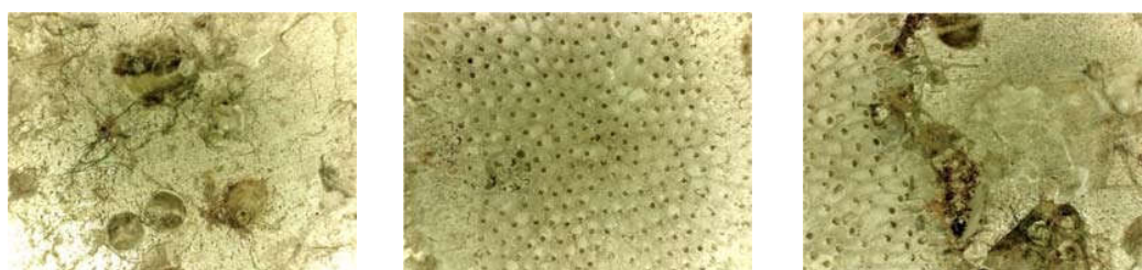
Рис. 8. Микрофотография поверхности стали 08X13 после 30 сут выдержки в морской воде на МНИИС Дам Бай и химического травления \times 80
