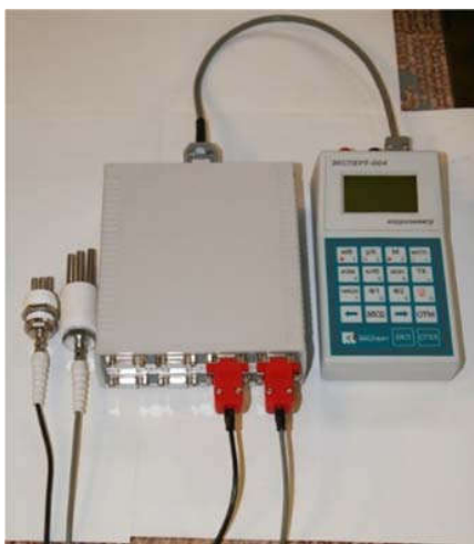
Рис. 1. Автоматический коррозиметр "Эксперт-004" с коммутатором
