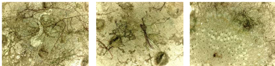
Рис. 11. Микрофотография поверхности стали HS5-T после 30 сут выдержки в морской воде на МНИИС Дам Бай x80
