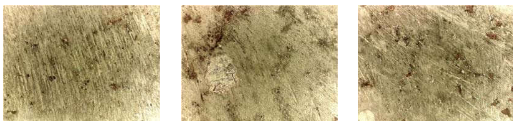
Рис. 8. Микрофотография поверхности стали 08X13 после 30 сут выдержки в морской воде на МНИИС Дам Бай и химического травления \times 80
