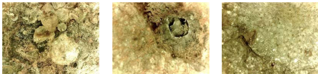
Рис. 7. Микрофотография поверхности стали 08X13 после 30 сут выдержки в морской воде на МНИИС Дам Бай \times 80
