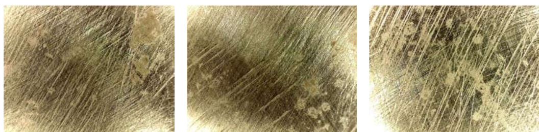
Рис. 12. Микрофотография поверхности стали HS5-T после 30 сут выдержки в морской воде на МНИИС Дам Бай и химического травления x80
