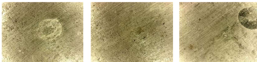
Рис. 10. Микрофотография поверхности стали 12X18H10T после 30 сут выдержки в морской воде на МНИИС Дам Бай и химического травления \times 80
