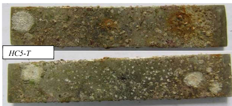
Рис. 6. Внешний вид поверхности сталей 08X13, 12X18Н10Т и HC5-T после 30 сут выдержки в морской воде на МНИИС Дам Бай
