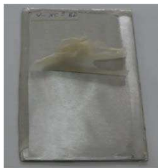
Mẫu sơn phủ M2 sau 1 chu kỳ thử nghiệm
