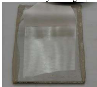
Mẫu sơn phủ M2 bóc khỏi bề mặt nhôm sau 10 chu kỳ thử nghiệm
