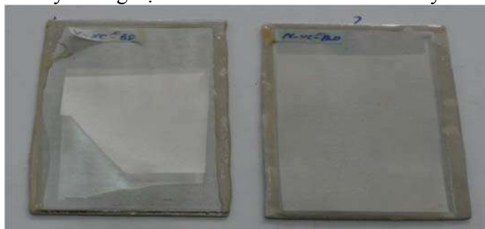
Mẫu sơn phủ M2 và XC-567 của LB Nga sau 10 chu kỳ thử nghiệm gia tốc
