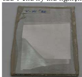
Mẫu sơn phủ M2 sau 10 chu kỳ thử nghiệm
