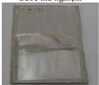
Mẫu sơn phủ M2 sau 3 chu kỳ thử nghiệm
