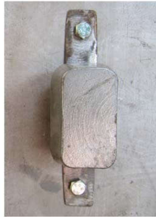
Hình 1. Protector kẽm được gắn trên mẫu thử nghiệm
