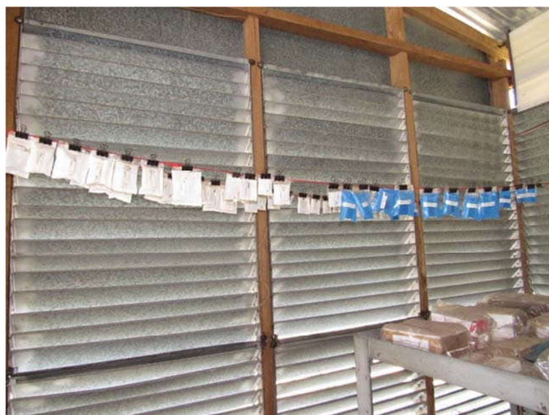
Рис. 4. Натурные коррозионные испытания образцов из Ст3, М1, Ц0 и Д16, упакованных в ингибированную пленку, содержащую ИФХАН-112 в жалюзийном хранилище МНИИС Дам Бай
