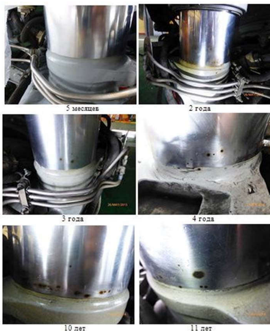
Рис. 7. Внешний вид точечной коррозии штока амортистойки самолетов Су-30МК2 на соответствующем году эксплуатации в тропиках
