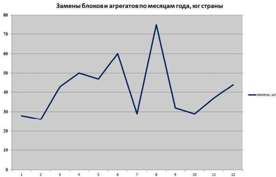
Рис. 4. Распределение количества замен блоков и агрегатов на самолётах, эксплуатирующихся на юге страны
