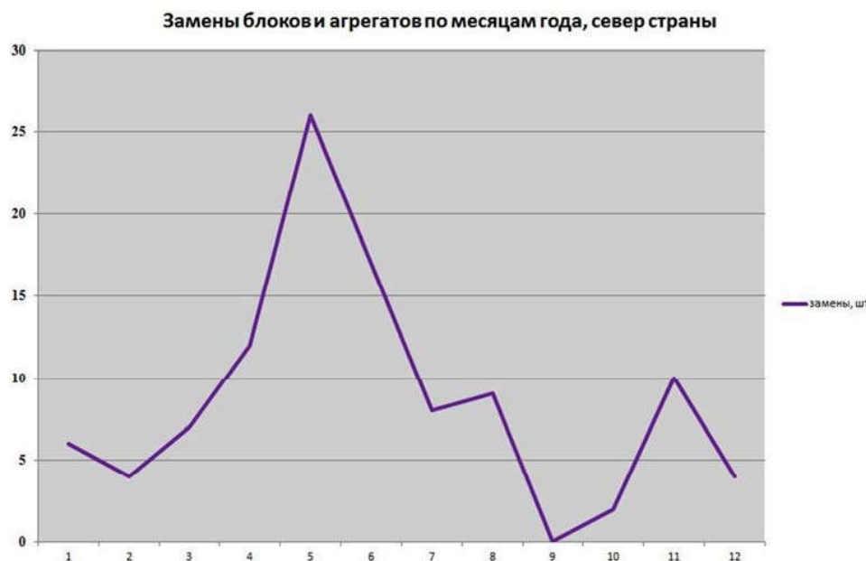
Рис. 3. Распределение количества замен блоков и агрегатов на самолётах, эксплуатирующихся на севере страны
