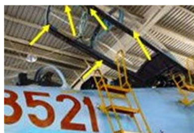
Рис. 9. Стрелками указаны зоны, где наиболее часто выявляются места разрушения шлангов герметизации
