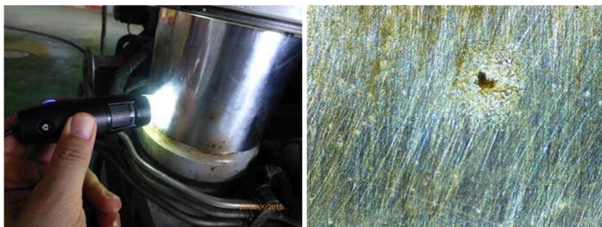
Рис. 5. Осмотр с помощью микроскопа РСЕ-ММ пятен коррозии на штоке амортизатора (слева) и точечная коррозия штока крупным планом
