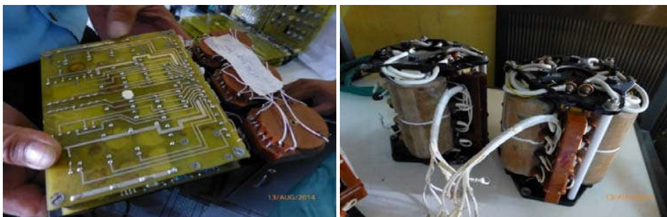
Hình 7. Ảnh chụp khối H001-22II nhìn từ bên ngoài - hỏng biến áp trong khối nguồn
