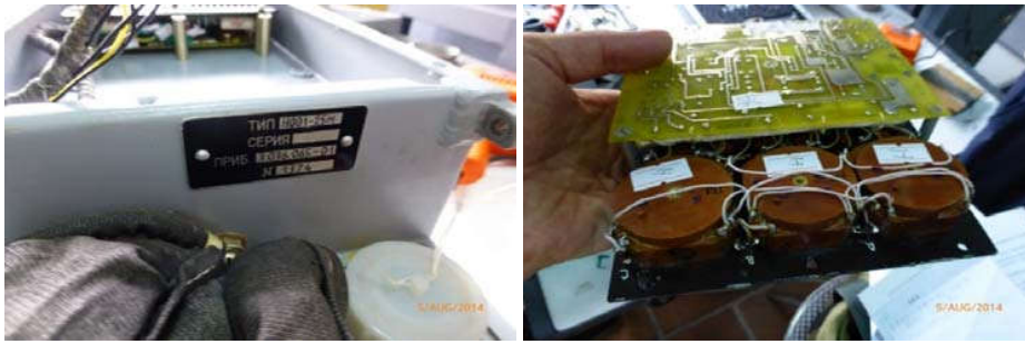
Hình 5. Ảnh chụp khối H001-25M nhìn từ bên ngoài - hỏng biến áp
