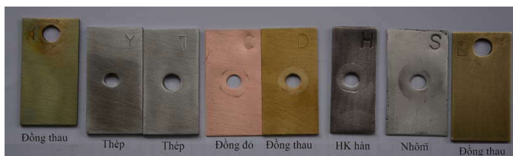
Hình 4. Bề mặt mẫu thử sau khi thử nghiệm trong dung dịch cromat trong glycerin theo JIS-K 2234:2006
