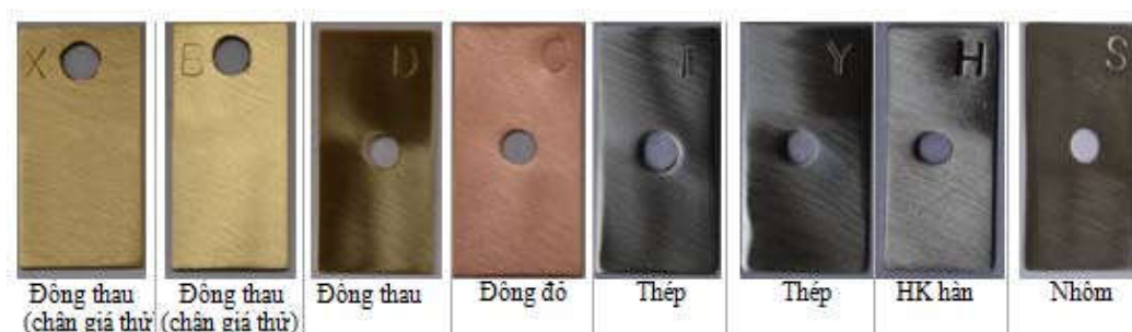
Hình 3. Hình ảnh mẫu thử trước khi thử nghiệm trong dung dịch cromat trong glycerin theo JIS-K 2234:2006
