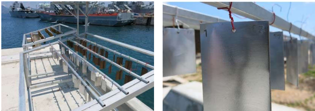
Hình 3. Thử nghiệm tốc độ ăn mòn kim loại tại cảng Cam Ranh
