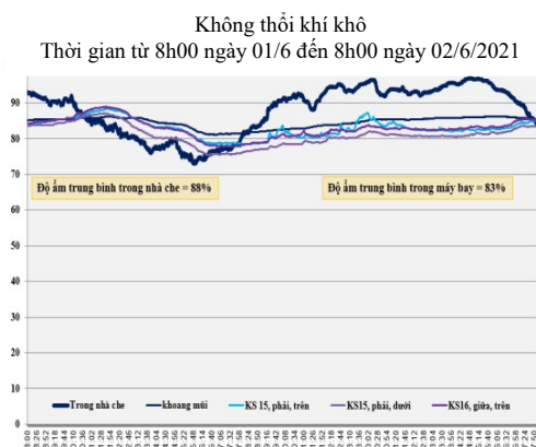
Hình 1. Độ ẩm trong nhà che và trong khoang thiết bị của máy bay Su-30MK2 tại Yên Bái
