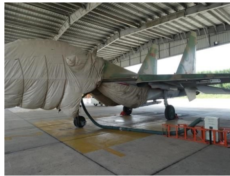
Hình 4. Thử nghiệm thổi khí khô cho máy bay Su-30MK2 (Yên Bái)
