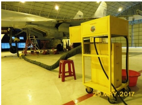
Hình 3. Thử nghiệm thổi khí khô cho máy bay Su-27SK (Đà Nẵng)
