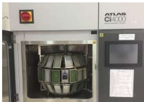
Hình 2. Các mẫu sơn đặt trong tủ bức xạ mặt trời, tủ ăn mòn trước khi thử nghiệm
