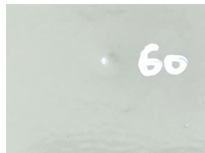
Độ bền và đập màng sơn epoxy sau 20 chu kỳ thử nghiệm
