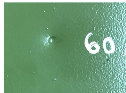
Độ bền và đập màng sơn polyurethan sau 20 chu kỳ thử nghiệm
