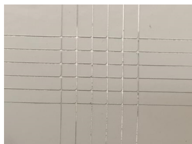
Độ bám dính màng sơn epoxy sau 20 chu kỳ thử nghiệm
