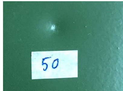
Độ bền và đập màng sơn alkyd sau 20 chu kỳ thử nghiệm
