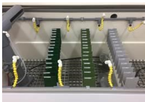
Hình 2. Các mẫu sơn đặt trong tủ bức xạ mặt trời, tủ ăn mòn trước khi thử nghiệm
