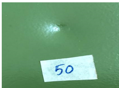
Độ bền và đập màng sơn polyurethan trước thử nghiệm
