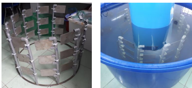
Hình 1. Cách bố trí mẫu và mô hình tạo dòng chảy vòng trong bể thử nghiệm
