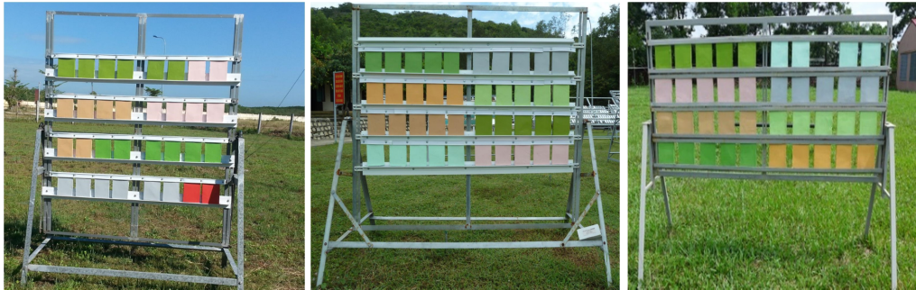
Hình 6. Các giá phơi mẫu sơn ngoại thất tại Cần Giờ, Đầm Báy và Hòa Lạc khi bắt đầu triển khai chương trình thử nghiệm
