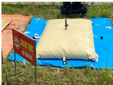
Bể màng polyme chứa xăng dầu bắt đầu thử nghiệm
