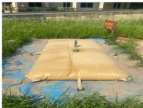
Bể màng polyme chứa xăng dầu sau 07 tháng thử nghiệm
