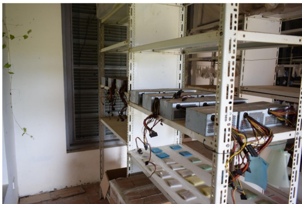
Hình 1. Nguồn điện cho máy tính trên giá thử nghiệm tại Trạm NCTNTN Hòa Lạc
