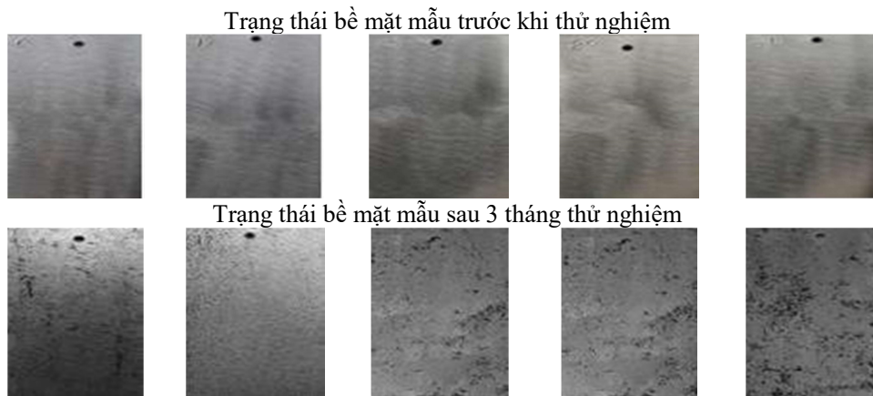
Hình 6. Trạng thái bề mặt mẫu kim loại trước và sau 3 tháng thử nghiệm đặt tại nhà che bãi đỗ máy bay Su-22 (Mẫu không được bảo vệ bằng khí khô)
