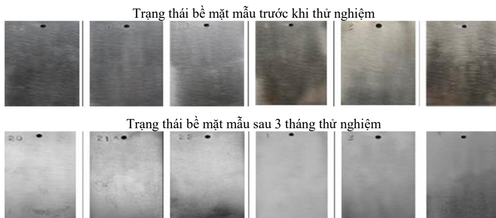
Hình 9. Trạng thái bề mặt mẫu kim loại trước và sau 3 tháng thử nghiệm đặt trong các khoang máy bay Su-22
