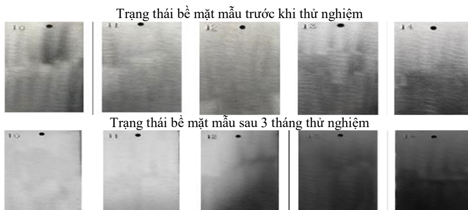
Hình 8. Trạng thái bề mặt mẫu kim loại trước và sau 3 tháng thử nghiệm đặt trong buồng giả lập số 4
