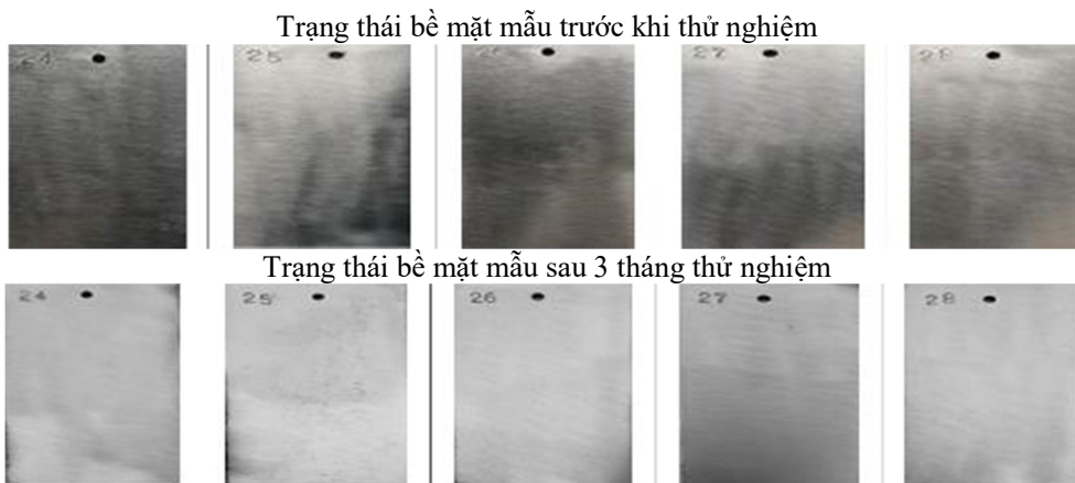
Hình 7. Trạng thái bề mặt mẫu kim loại trước và sau 3 tháng thử nghiệm đặt trong buồng giả lập số 1
