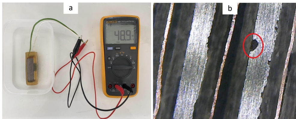
Hình 7. Ảnh đo dòng ăn mòn trên cảm biến (a) và pitting xuất hiện trên bề mặt cảm biến sau thời gian thử nghiệm (b)
