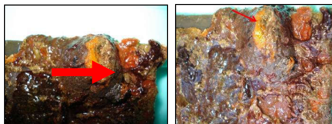
Hình 5. Bóng khí hình thành trên bề mặt mẫu
