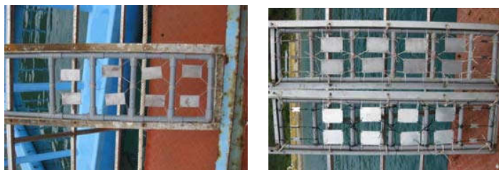
Hình 3. Mẫu thử nghiệm ăn mòn thép cacbon trong nước biển
