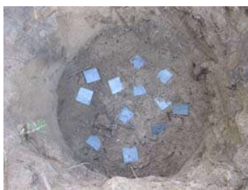
Hình 2. Đặt mẫu thử nghiệm tốc độ ăn mòn của thép trong môi trường đất
