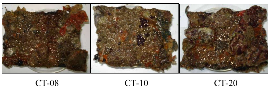
Hình 4. Các mẫu sau 15 tháng thử nghiệm tại Trạm Thử nghiệm Đầm Báy
