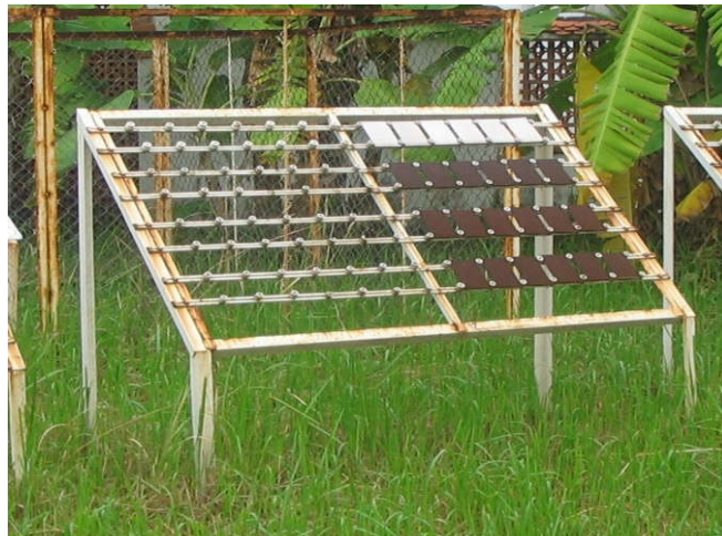
Hình 1. Giá phơi mẫu và các mẫu kim loại thử nghiệm
