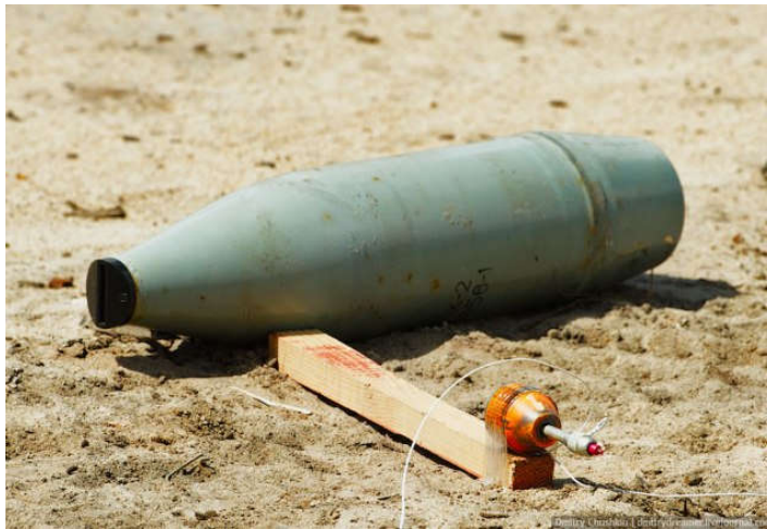
R-40 được lắp trên giá, chuẩn bị xử lý quả đạn chứa đầy thuốc nổ
