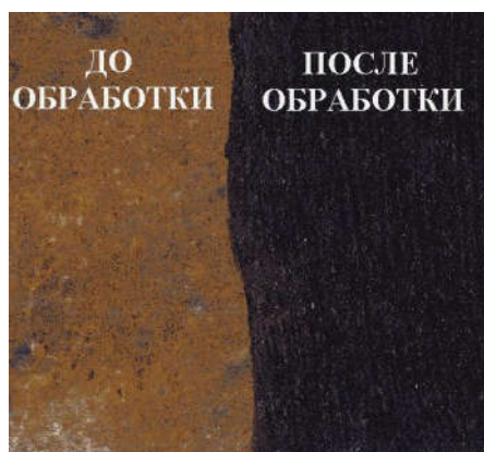
Hình 2. Bề mặt thép trước (nửa bên trái) và sau khi chuyển hoá (nửa bên phải)
