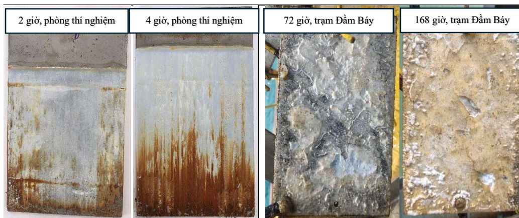
Hình 1. Bề mặt thép AH36 được phân cực ca-tốt trong nước biển tự nhiên
